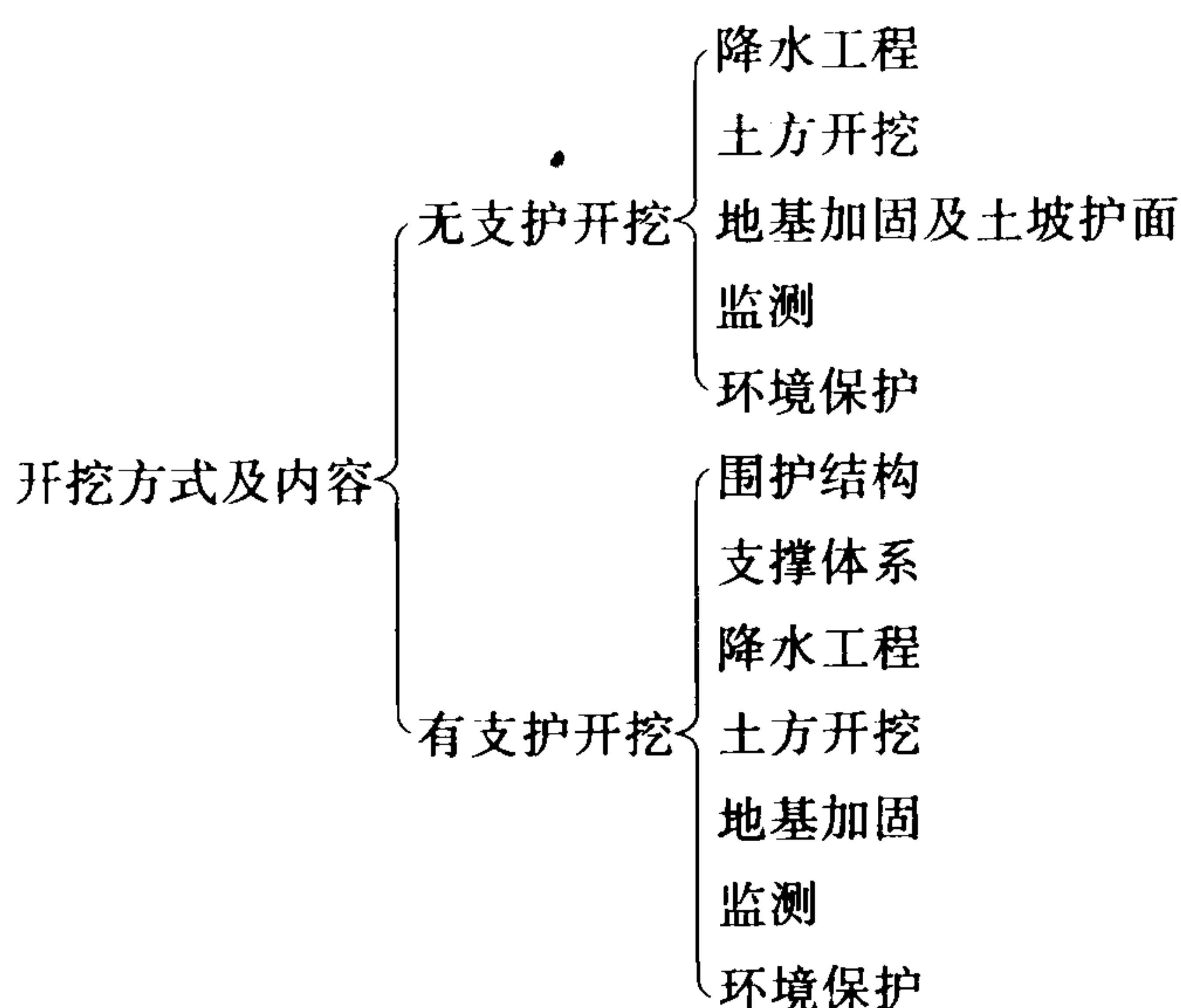
图 8-3-1 基坑开挖方式和内容
