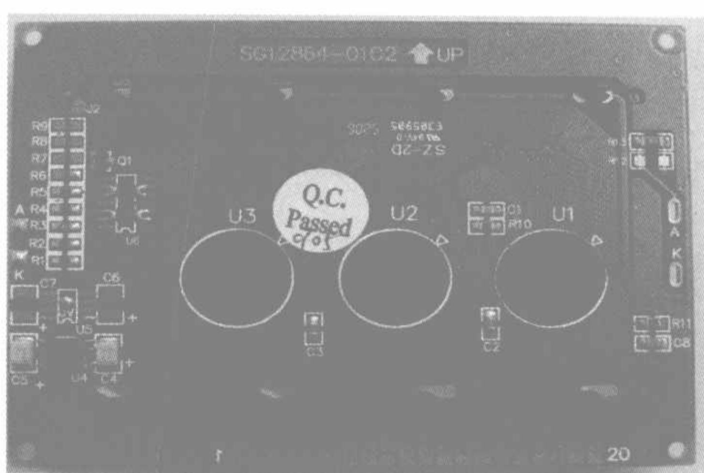
图 7.1.5 12864 液晶接口图
